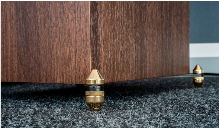
Die vier Spikes, auf denen das Gehäuse lagert werden mit Traversen leicht nach außen versetzt, um dem Lautsprecher Standfestigkeit zu verleihen. Eine Höhenverstellung erlaubt das Ausgleichen von Unebenheiten.
